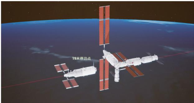
11月1日在北京航天飞行控制中心拍摄的空间站梦天实验舱与空间站组合体在轨完成交会对接。这是梦天实验舱从19米停泊点向天和核心舱前向端口靠近的模拟图像。新华社发
