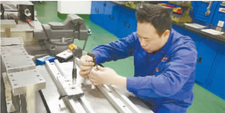
刘建伟在为某新型导弹装配检测装置校正底板导轨。 胡信松 摄
