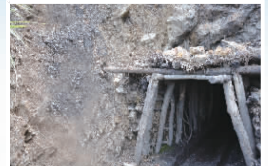
国家明令禁止的独眼井,因为只有一个洞口出入,没有必备的通风洞口和设施,很容易聚集瓦斯,引起爆炸。
