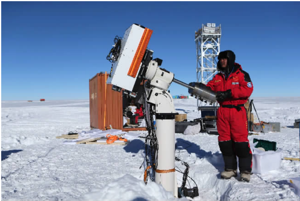
中国第35次南极科学考察队昆仑队9日在昆仑站完成南极太阳多色望远镜安装。这是昆仑站首台白天天文观测设备，可在极昼期间对太阳进行连续观测，同时开展空间碎片观测。图为南极太阳多色望远镜在昆仑站完成安装。
