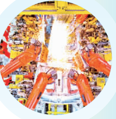
广汽菲克由18台机器人柔性结合的集成焊接工位,是焊装车间的关键核心工序。
