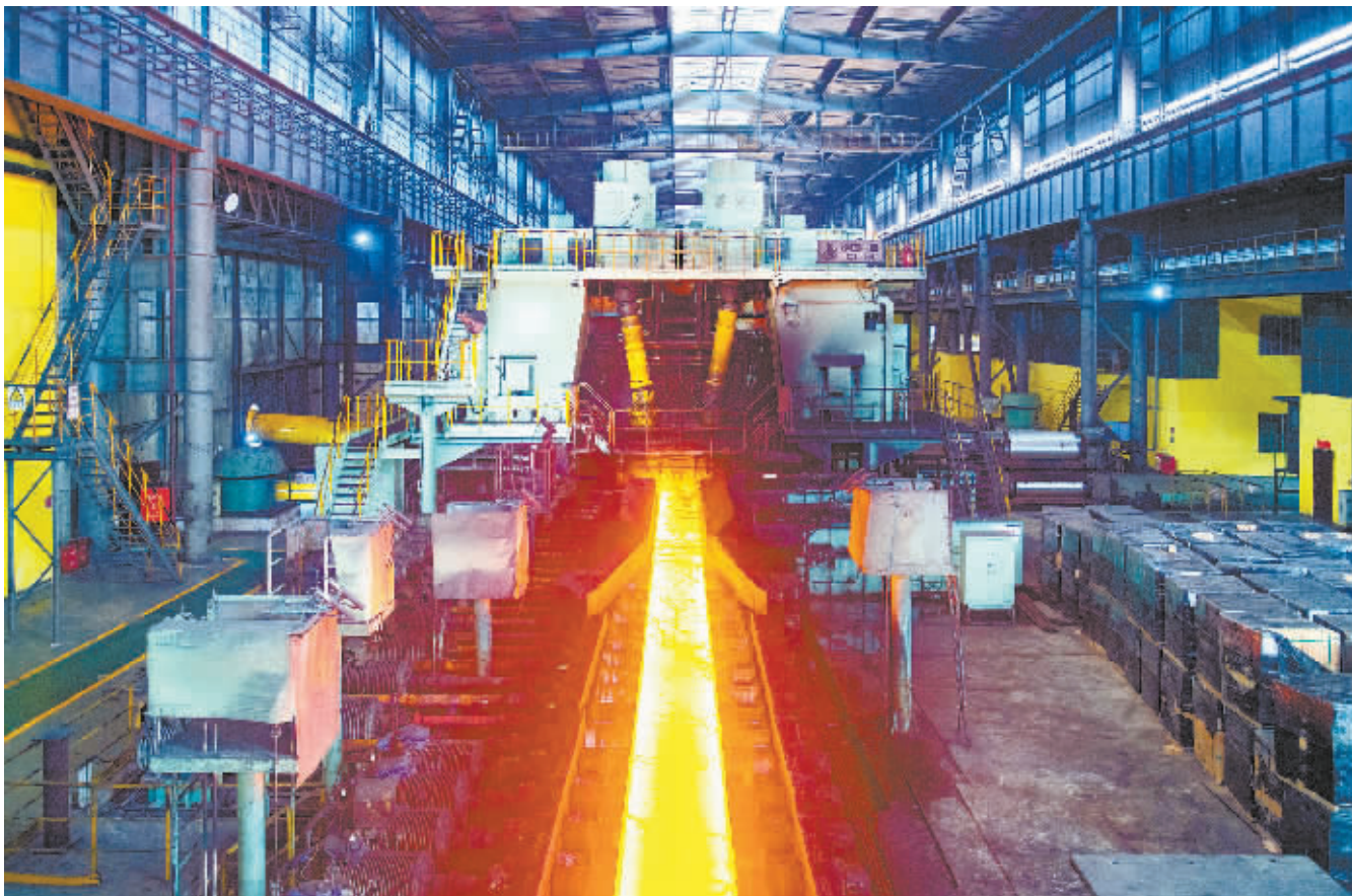
5月23日,湖南华菱涟源钢铁有限公司2250热轧板厂,加热后的钢坯经深加工后,成为厚度和宽度满足精轧要求的中间板坯。(资料照片) 湖南日报记者 唐俊 通讯员 严安 摄影报道
