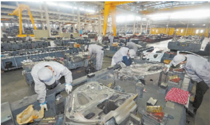
3月24日，湘潭屹丰汽车部件生产车间，工人在精心打磨汽车部件(车门)。
