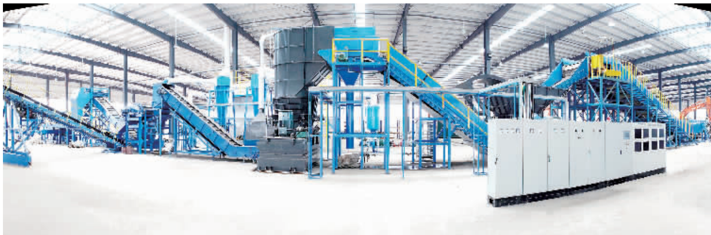
万容科技报废汽车车身破碎分选与废钢加工一体化设备。
